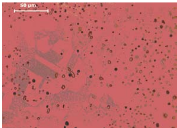
Figura 7. Microestructura de trabajado y recocido en el fragmento del sector vecino a la boca. Se observan granos de recristalización con maclas de recocido en su interior (zonas delimitadas por bordes rectos). Los puntos negros son restos de pátina.
